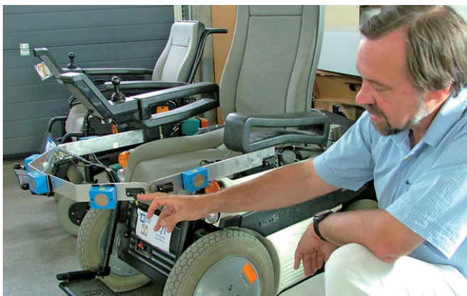
Professor Schilling zeigt ein Entwicklungsmodell, das mit Sensortechnik versehen später einmal Hindernisse von selbst erkennt und darauf reagiert.
